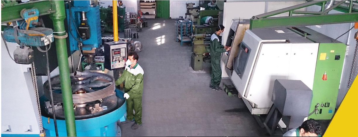
تولید پولی تا قطر ۱۶۰۰ میلیمتر با دستگاه های کاروسل ، تراش CNC
